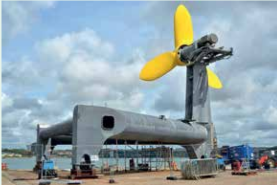
Подводный электрический генератор DeltaStream мощностью 400 кВт,
